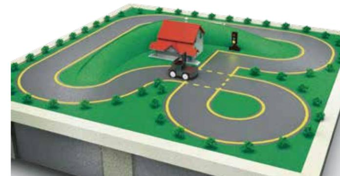
深度学习无人驾驶智能车沙盘套件产品主要包含无人驾驶智能车ARTROBOT-HDK以及深度学习无人驾驶沙盘ARTROBOT-D ST, ARTROBOT-HDK以深度学习框架为基础，搭载超声波、近红外、陀螺仪、地磁、蓝牙等传感器、双摄像头配置，可实现数据采集、模型构建、车道线、限速标志、弯道待转、信号灯等交通标志的识别，系统覆盖深度学习及无人驾驶视觉算法知识点应用。
